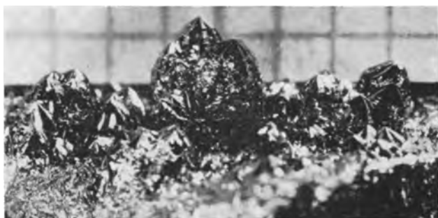
Fig. 3. Crystal growth on Si layer (x 10½)
